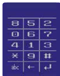
Clavier rotatif (pour empêcher l'analyse de surface)
