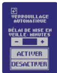
Fonction de verrouillage automatique (éteint automatiquement l'appareil en cas d'inactivité)
